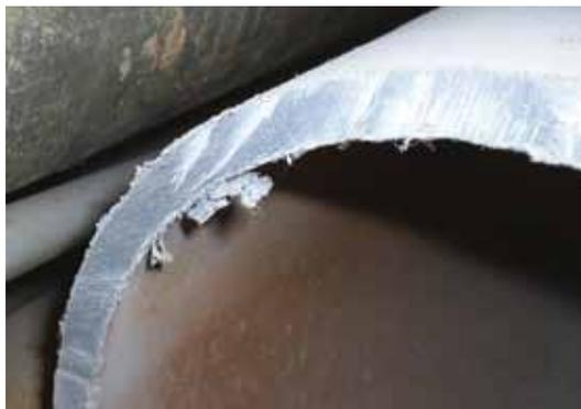
Figura 9. Ejemplo de material friable: tubería de agua
